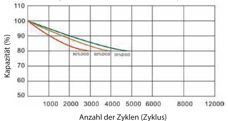
Zykluslebensdauer mit DOD bei 25°C, 0.2C
