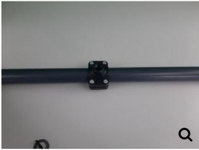
Montieren Sie die Aufnahme mit den mitgelieferten Schrauben und Muttern. Sorgen Sie dafür, dass die Aufnahme einen festen Sitz um das Rohr hat und sich nicht mehr verrücken lässt.
