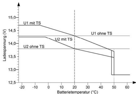
**Bei 24 V- Nennspannung alle angegebenen Spannungen x2 nehmen!**
