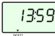
Zur Einstellung der Uhrzeit muss die Uhr-Taste für 3 Sekunden gedrückt werden, bis am oberen Rand der Anzeige „Set“ erscheint und die Stunden der Uhrzeit blinken. Mit den Pfeil-Tasten können nun die Stunden eingestellt werden. Ein kurzer Druck auf die Uhr-Taste springt zur Einstellung der Minuten um. Nun blinken die Minuten und können mit den Pfeil-Tasten verstellt werden.
